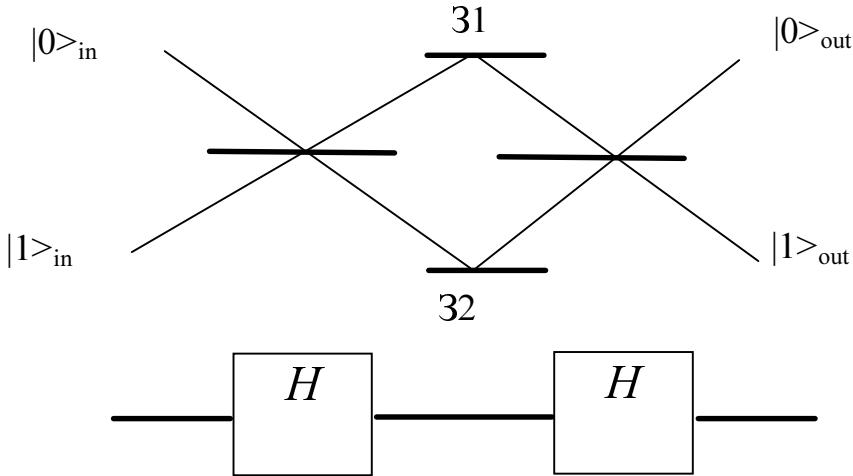
В данном случае зеркала (31 и 32) нужны только для того, чтобы перенаправить пучки. Действие интерферометра как последовательность двух ЛЭ Адамара представляется в виде:
