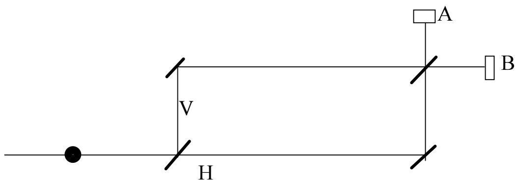
На рисунке изображена оптическая схема, представляющая собой последовательное соединение двух светоделителей, так, чтобы выходные плечи первого служили бы входными плечами для второго. В таком интерферометре относительная фаза между двумя плечами равна нулю.
