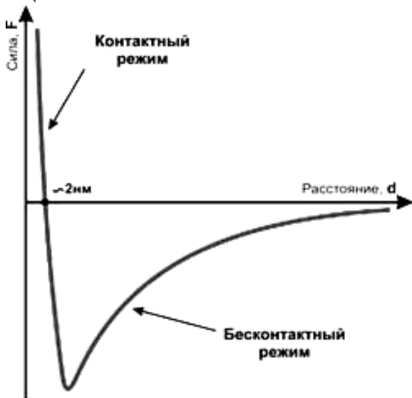
Рис. 3.4. Зависимость силы межатомного взаимодействия от расстояния между острием и образцом
