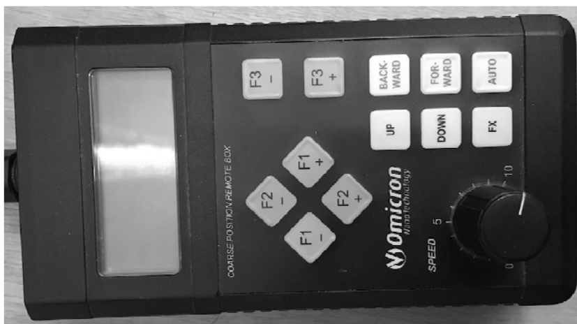
Рис. 3.35. Пульт управления подводом образца к зондирующему острию
