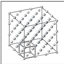
гранцентрированная кубическая решетка: вид семейства плоскостей, параллельных плоскости  $(\bar{1}11)$
