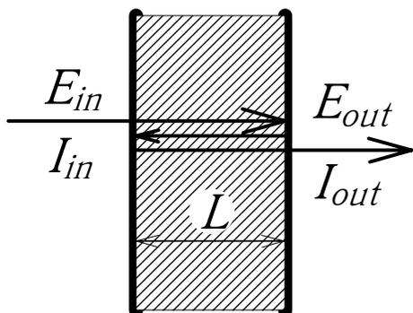
Рис.1. Интерферометр Фабри-Перо с нелинейной керровской средой.
