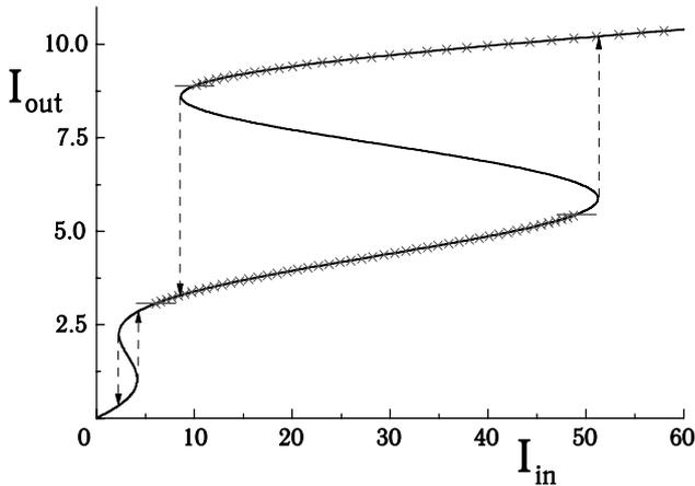
Рис.2. Зависимость  $I_{out}(I_{in})$ ,  $R = 0.5$ ,  $\varphi_0 = -3\pi/4$ ,  $\gamma = 1$ . Пунктиром показаны направления скачков с одной устойчивой ветви на другую, крестиками выделены области осциллирующего или хаотического поведения системы.
